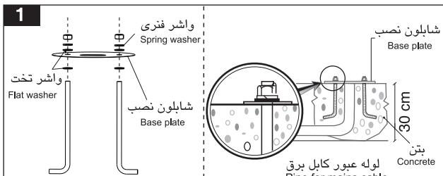
در هنگام نصب از تراز بودن شابلون نصب با سطح زمین اطمینان حاصل کنید.
