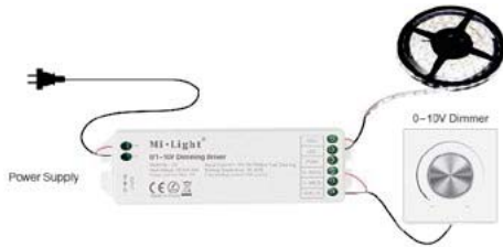
تنظیم نور خروجی چراغ با دیمر (1-10V DC )
