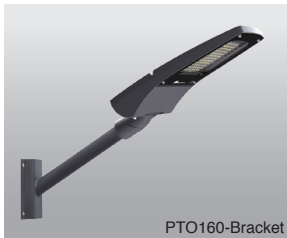
براکت نصب روی دیوار با زاویه نصب 30^\circ درجه نسبت به افق، قطر ۶۰ میلی‌متر و طول ۵۰ سانتی‌متر
